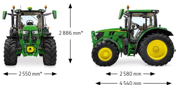
\* Avec des pneus avant 540/65R24 et des pneus arrière 600/65R38
